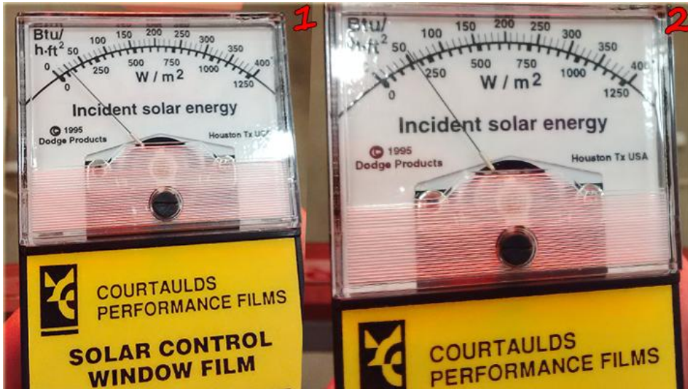
Obr. č. 8: Přístroj na měření propustnosti tepelné energie (Zdroj: Vlastní materiál)
